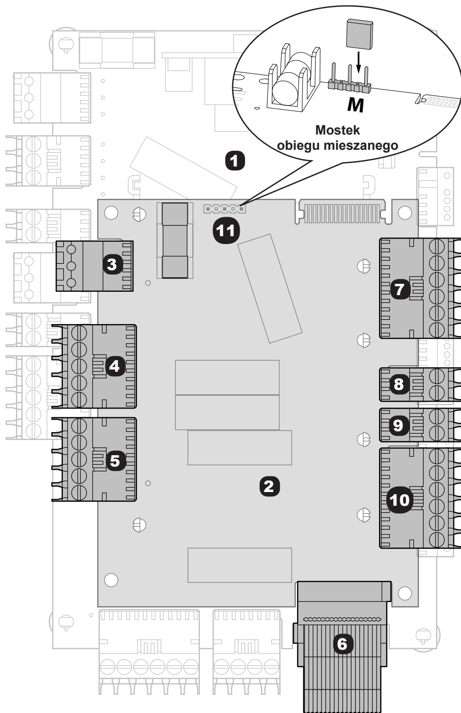
Złącze 3: do pompy ciepła; złącza 4, 6, 8 dostarczone z kartą (w opcji rozszerzenia regulacji)
