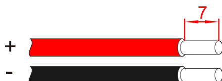
Rysunek 3-16 Usunąć izolację z przewodu wejściowego łańcucha PV (jednostka: mm)
