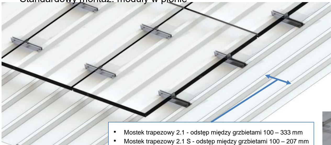
Mostek trapezowy 2.1, L=400mm Opcjonalnie: mostek trapezowy 2.1 S, L=250mm
